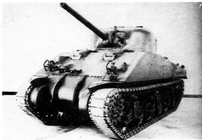
Первый серийный танк М4А2. Обращают на себя внимание два курсовых пулемета, установленных посередине лобового листа корпуса.
