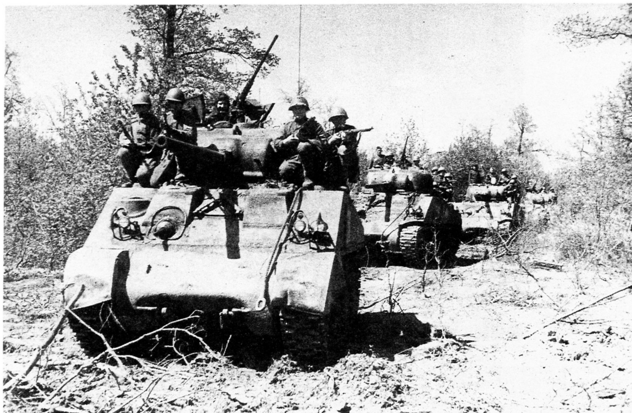
Колонна танков М4А2 Красной Армии с десантом на броне. Удержаться на «Шермане» было делом трудным, поскольку на танке полностью отсутствовали какие-либо приспособления (поручни, скобы) — в американской армии мотопехоту перевозили на бронетранспортерах и автомобилях.
