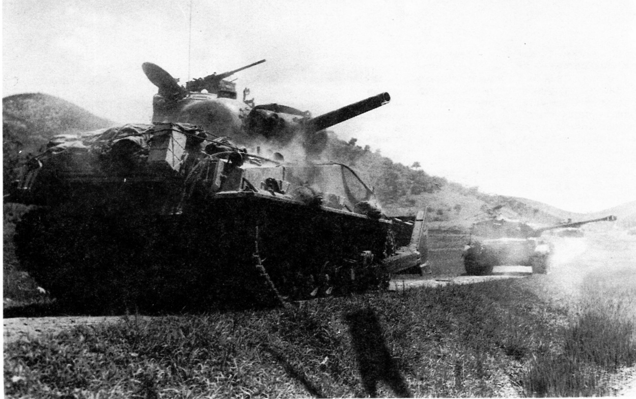
Гаубичный танк М4А3(105) HVSS 1-го танкового батальона морской пехоты, оборудованный бульдозером М1, поддерживает огнем солдат 5-й дивизии морской пехоты близ Вонсана. Корея, 18 августа 1950 года. На втором плане средний танк М26 «Генерал Першинг».
