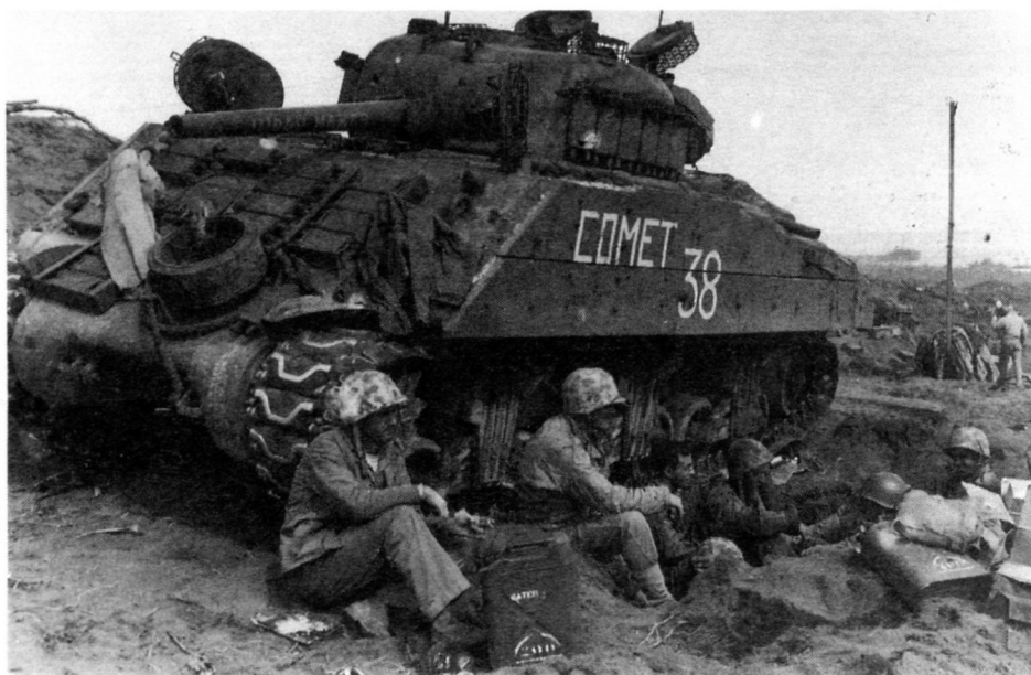
M4A2(W) роты «С» 4-го танкового батальона морской пехоты на Иводзиме, февраль 1945 года. Машина имеет разного рода дополнительную защиту, учитывающую применяемую японской пехотой тактику борьбы с танками. Почти все танки морской пехоты имели собственные названия.
