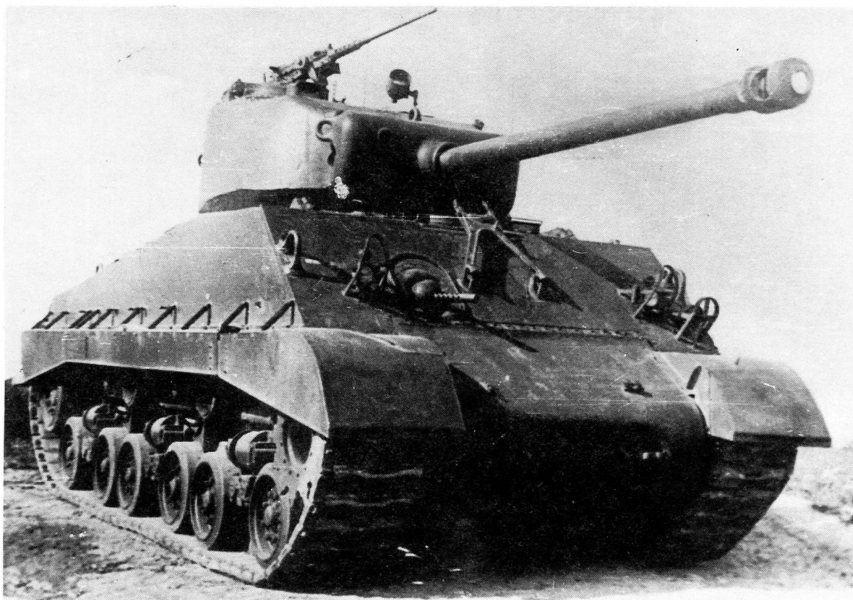
Средний танк M4A2(76)W HVSS с горизонтальной подвеской и 23-дюймовой гусеницей во время испытаний на НИИБТ Полигоне в Кубинке. 1945 год.
