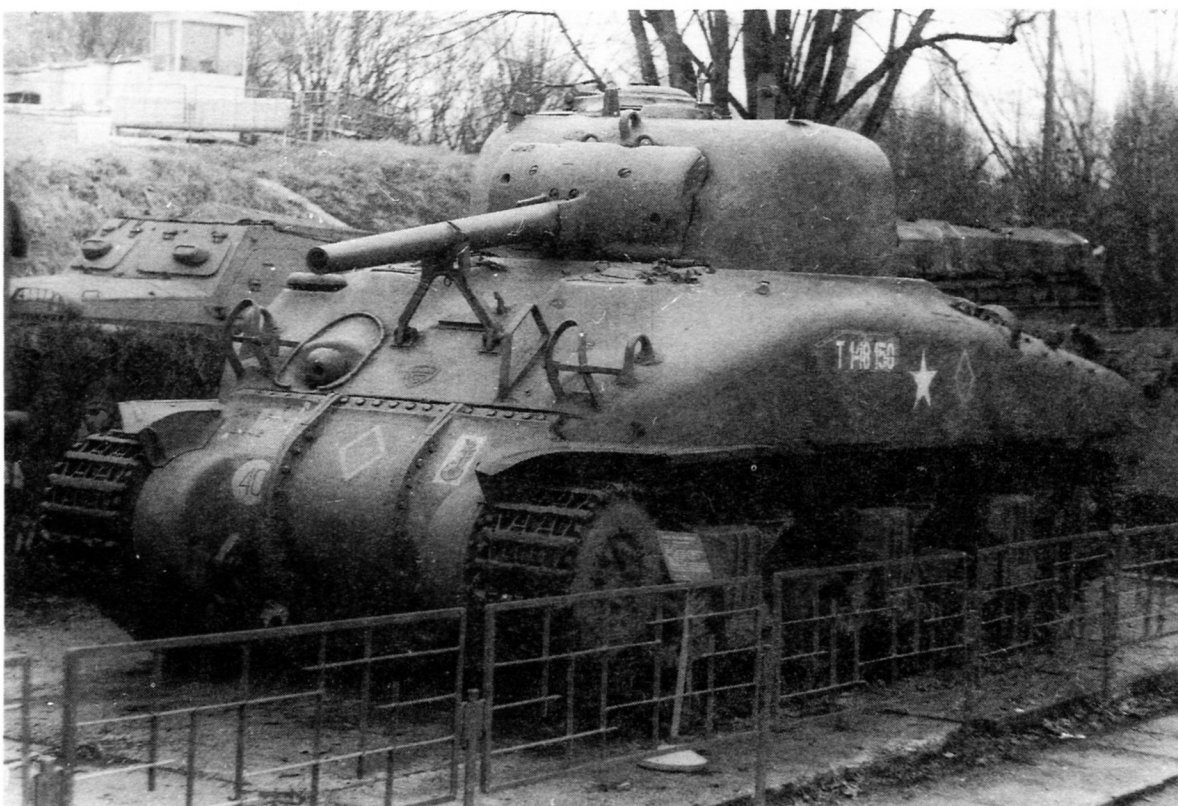
Grizzly I в экспозиции Музея Войска Польского в Варшаве. Для этого танка характерно сочетание черт ранних и поздних моделей M4A1: составная лобовая деталь, выполнявшая роль крышки трансмиссионного люка и картера двойного дифференциала, соседствует с командирской башенкой и кронштейном крепления пушки по-походному. Обращают на себя внимание гусеница и ведущее колесо канадского образца.
