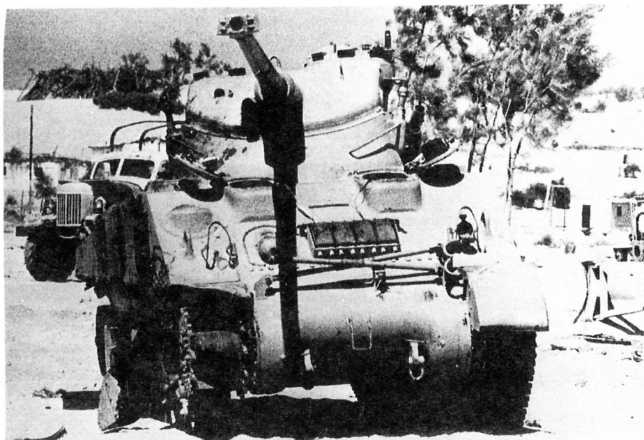
Египетский танк М4А4, оснащенный башней FL10 французского легкого танка AMX-13. Синайская пустыня, 1967 год.
